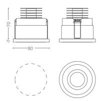
FORO DI PREINSTALLAZIONE Ø73mm
